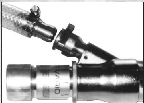
INJEKTORKING VARIO EPS med trinløs variabel justering af luftmængden samt lynkobling for materialeslange.
