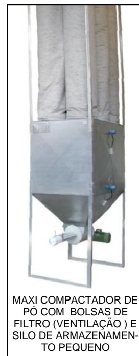
DUST-FLEX MAXI - COMPACTADOR DE POEIRA FLEXÍVEL COM UM SILO PEQUENO. PARA SER ENCHIDO MANUALMENTE - NENHUM TRANSPORTE POR AR. DISPONÍVEL COM RODAS OU PÉS.
