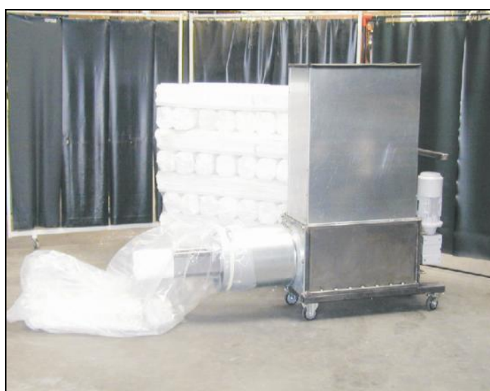
Styropactor MINI 1-FASET med kompakterede stykker stablet på en palle.
