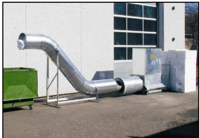
Styropactor Maxi med rampe der skubber EPS direkte op i en container.
