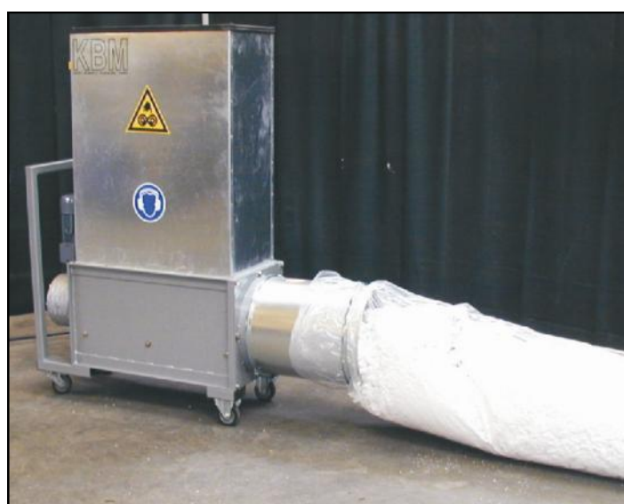
Styropactor MINI som knuser med fyldning direkte i en plasticpose.
