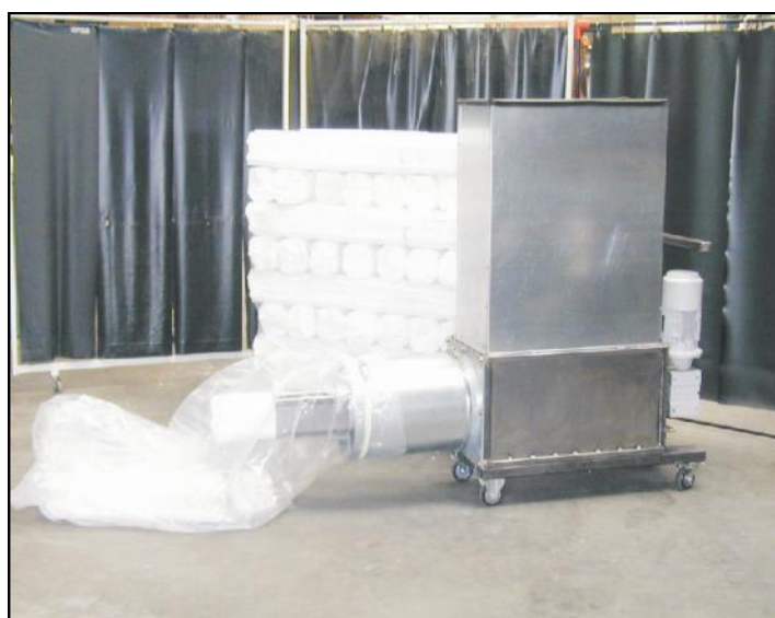
Styropactor MINI 1-FASE con le parti compresse impilate su una paletta.
