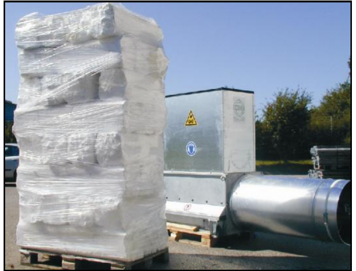
Styropactor MAXI: .Parti compresse impilate su un palleta per il trattamento facile.
