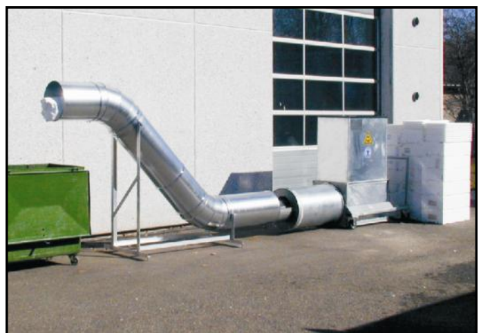
Styropactor Maxi con rampa che lo spinge direttamente in un contenitore.
