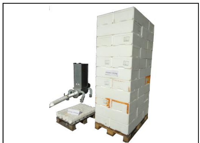
Styropactor NANO "Styropor-billen" med 33 fiskekasser. 33 ikke kompakterede og 33 kompakterede
