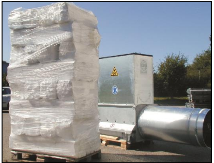
Styropactor MAXI: Kompakterede stykker på en palle for em håndtering.
