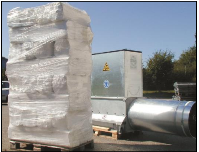
Le Styropactor MAXI: Quand les pièces compactées sont empilées sur une palette cela permette une manutention facile.
