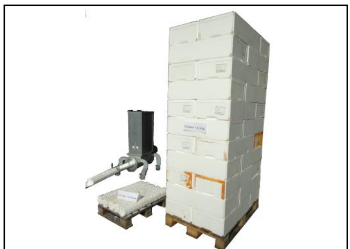
Le Styropactor NANO « Scarabée PSE » avec 33 caisses de poissons. 33 non-compactées et 33 compactées.
