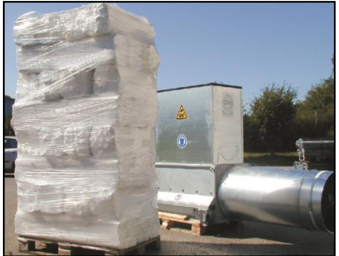
Styropactor MAXI: Parti compresse impilate su un palleta per il trattamento facile.
