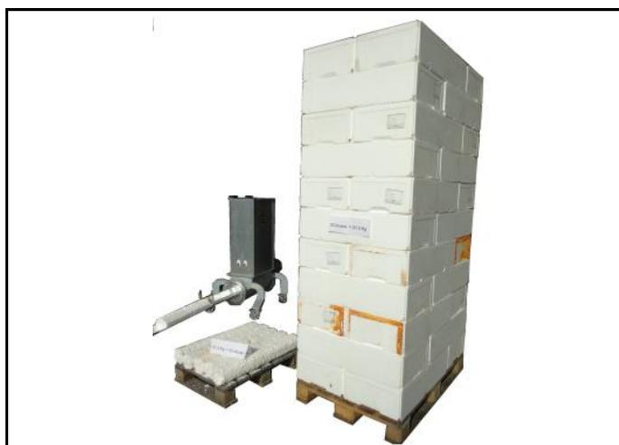
O Styropactor NANO "Besouro de Isopor" com 33 caixas de peixe. 33 não compactado e 33 compactadas.
