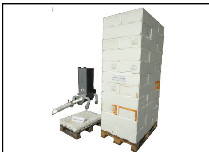
El Styropactor NANO "Escarabajo EPS" con 33 cajas de pescado. 33 no compactado y 33 compactado.
